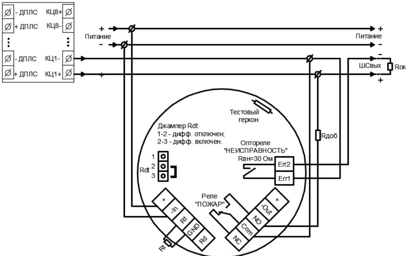
Рисунок 7 – 4-х проводная схема подключения к С2000-АР2 (АР-8)
