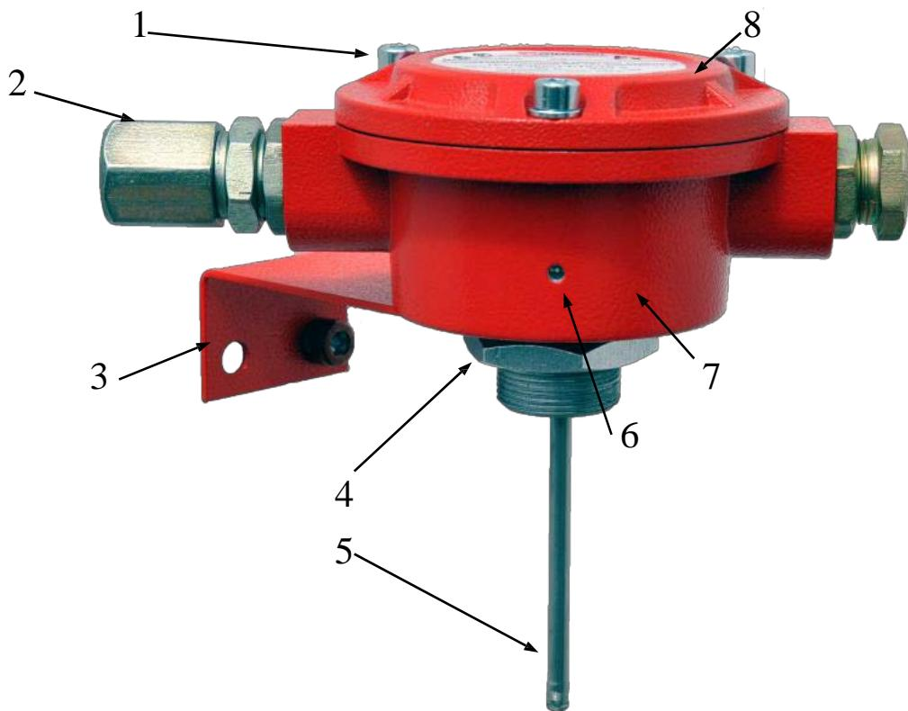
1 – винт M6 с шайбой; 2 – кабельный ввод; 3 – крепежное устройство (К-05); 4 – гайка M30x1,5; 5 – чувствительный элемент; 6 – светодиодный индикатор; 7 – корпус извещателя; 8 – крышка извещателя.
