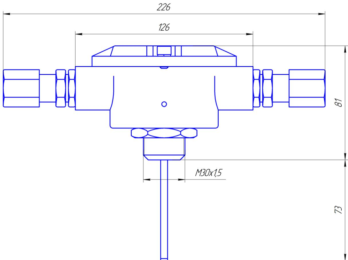
Рис. 1 – Извещатель пожарный тепловой Спектрон-101-Т-Р-Exd-А
