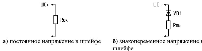
**Рисунок 6.** Оконечный элемент контроля шлейфа ППКП.
