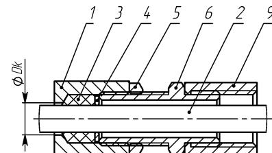
б) монтаж в трубной разводке с помощью штуцера ШТ
