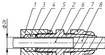
а) монтаж бронированным кабелем в кабельном вводе KVБ12
