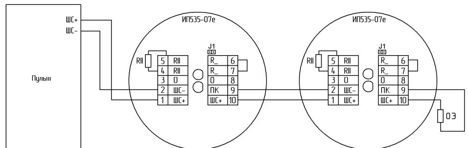
в) Схема подключения ИП535-07е на замыкание
