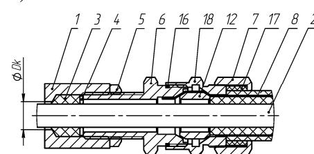
з) монтаж бронированным кабелем в кабельном вводе KVБУ
