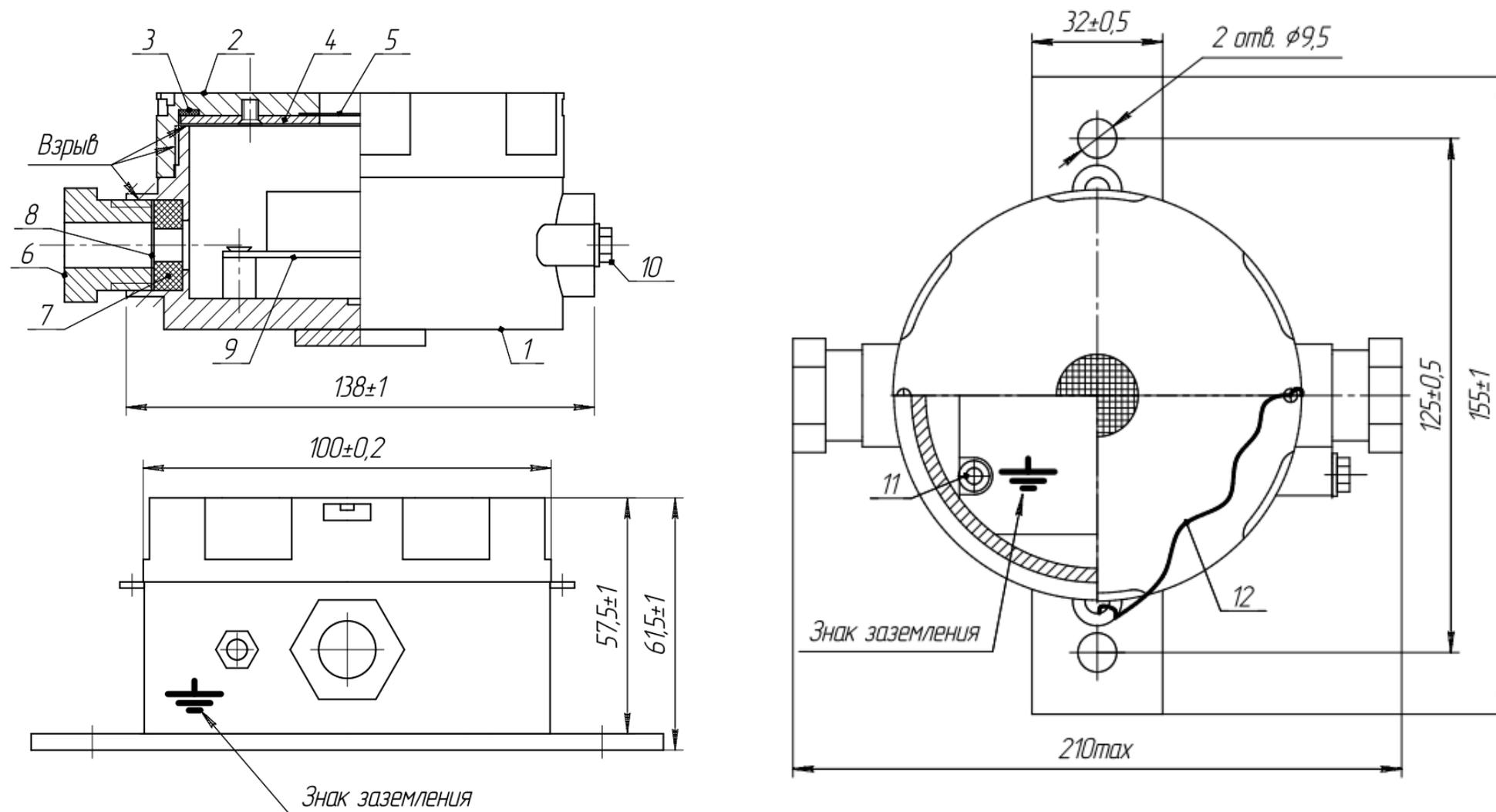
1 Основание; 2 крышка; 3 герметизирующая прокладка; 4 держатель сетки; 5 защитная сетка; 6 кабельный ввод; 7 уплотнительное кольцо для кабеля; 8 шайба; 9 плата с излучателем звука; 10 болт заземления; 11 заземление; 12 проволочная скрутка.
