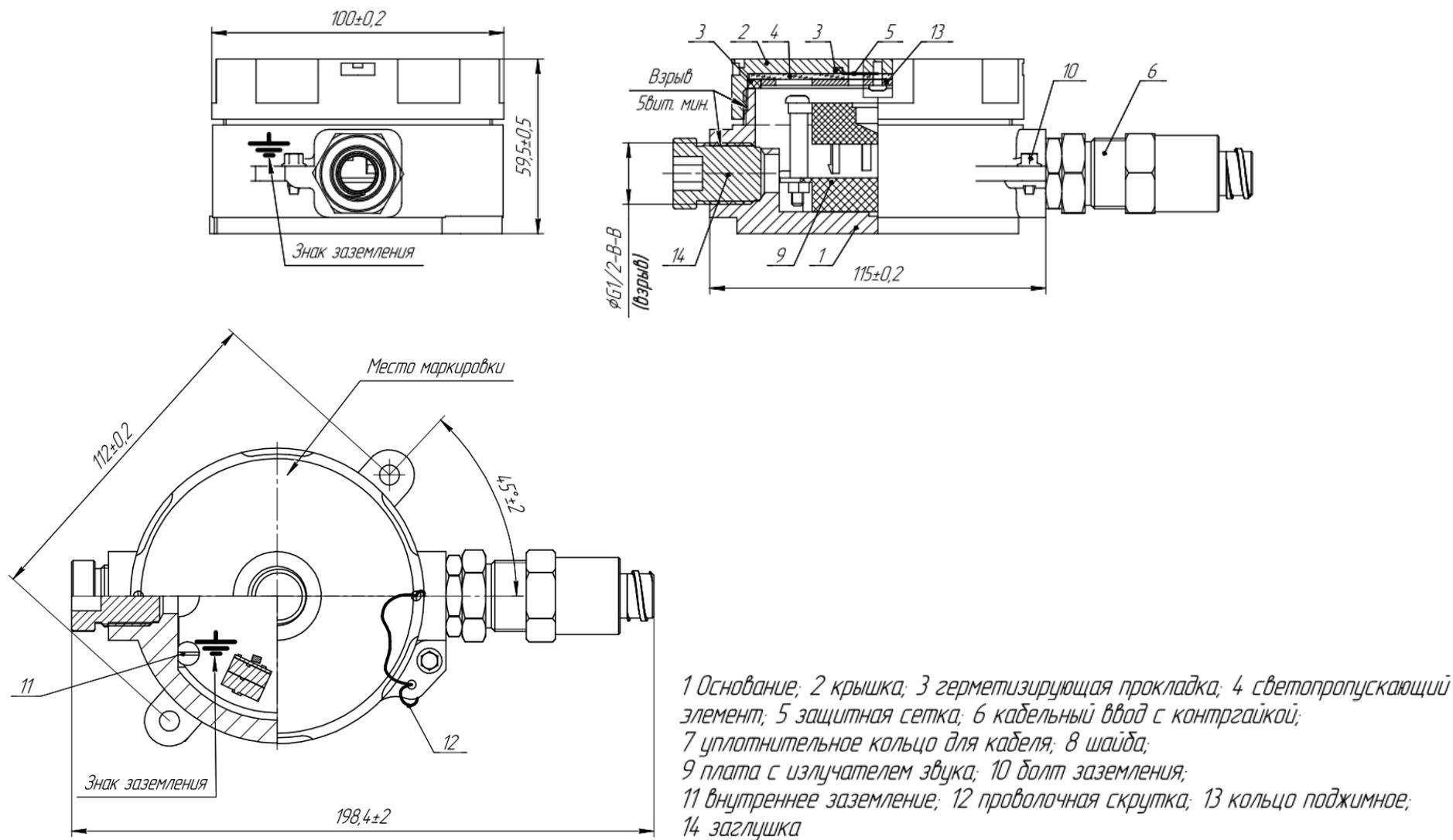
**Рис.А1 Конструкция звукового оповещателя Орбита МК 3 А (корпус из алюминиевого сплава).**
