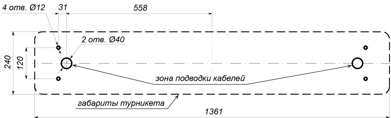
Рисунок 16. Схема разметки для установки стойки турникета
