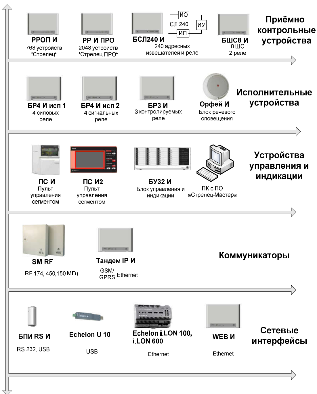
Рисунок 6. Состав оборудования сегмента
