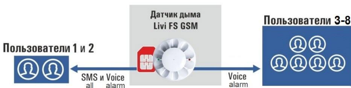
Рис. 9.1. Возможная конфигурация при передаче извещений датчиком на телефоны пользователей
