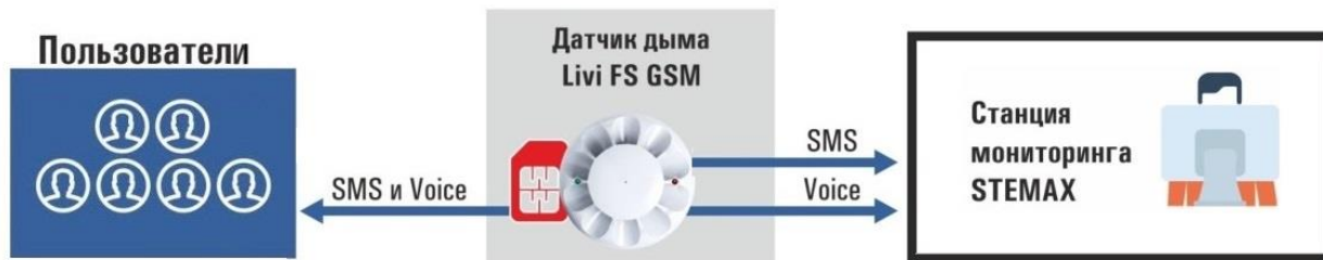
Рис. 9.2. Рекомендуемая конфигурация при передаче извещений на сервер STEMAX
