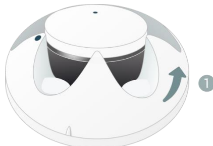
Рис. 5.1. Вскрытие корпуса датчика
