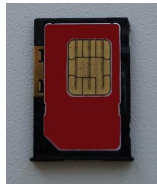
Рисунок 3.7 — Фиксатор с установленной SIM-картой
