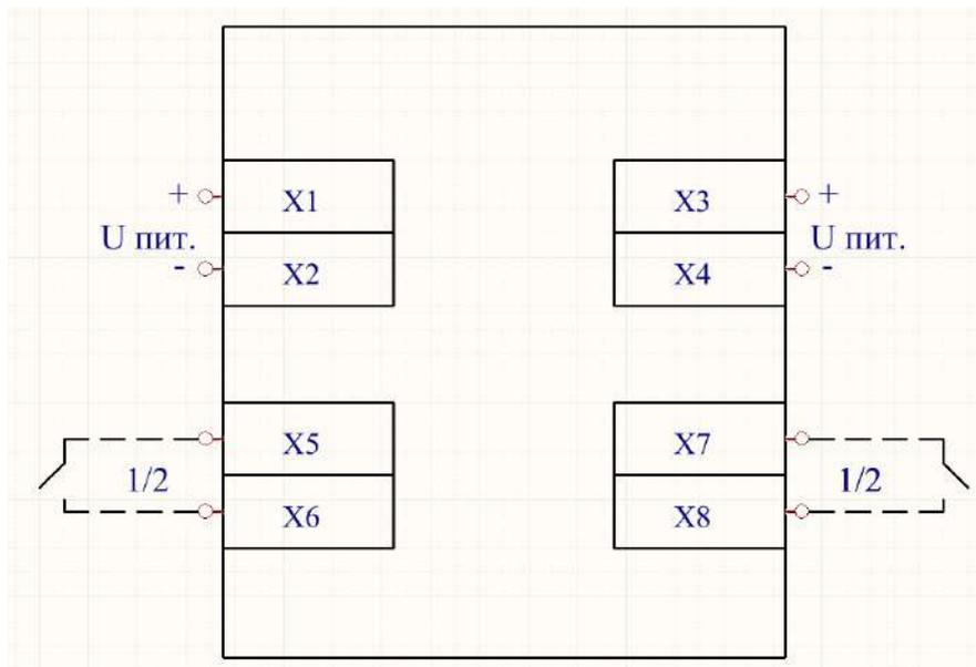
X1,X2 и X3,X4 – клеммы питания (U+/U- или 220В); X5,X6 и X7,X8 – клеммы управления второй ступенью; X9,X10 – клеммы подключения светодиода.
