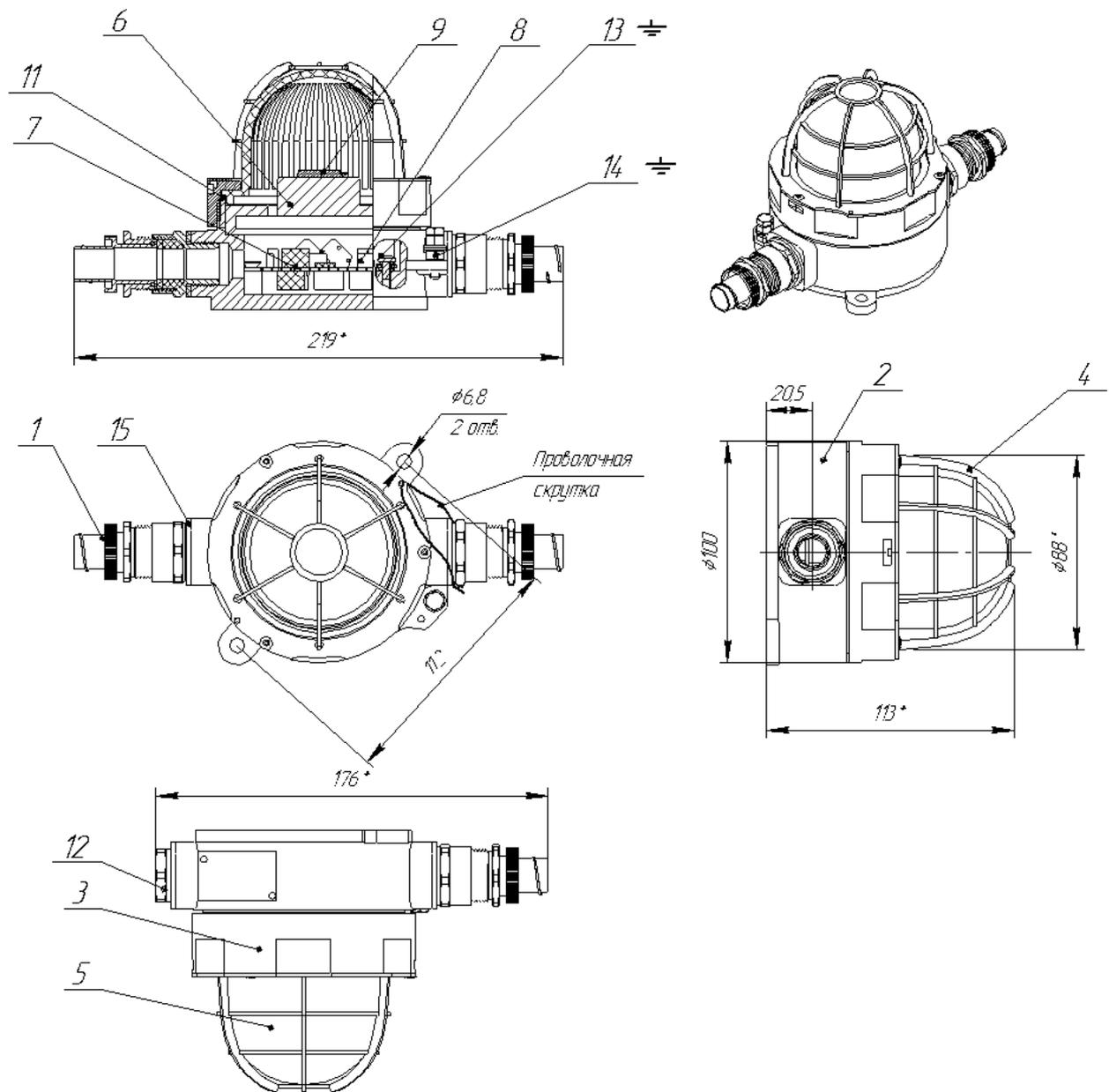
**Рис. А1 Конструкция светового оповещателя ОРБИТА МК М - С**
