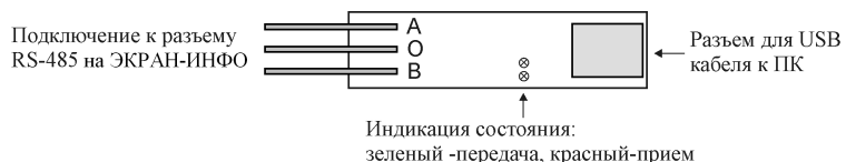
Рисунок 5. Расположение контактов преобразователя ПИ1.
