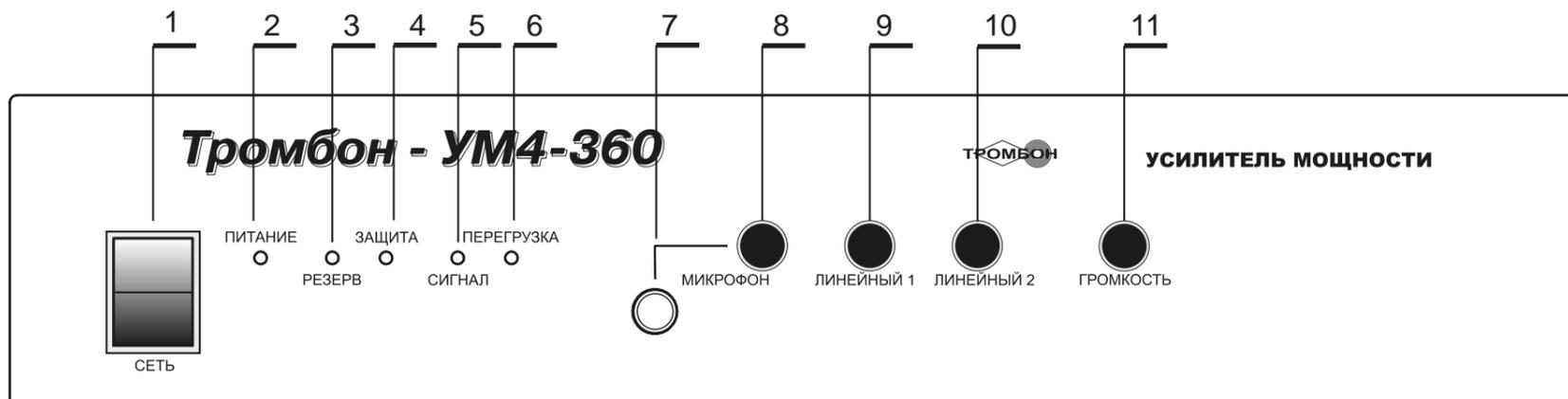
Рис. 1 Эскиз передней панели Усилителя.
