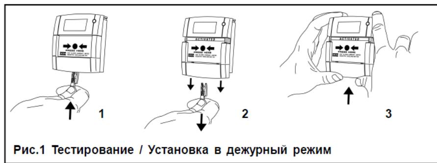
Рис.1 Тестирование / Установка в дежурный режим
