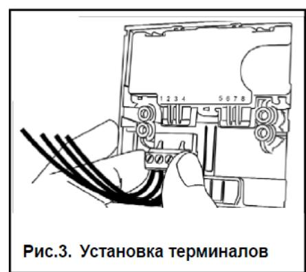
Рис.3. Установка терминалов
