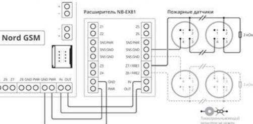
Длина линии связи ограничена сопротивлением кабеля. Для кабеля типа КСПБГ 4х0,2 с сопротивлением одной жилы 95 Ом/км максимальная длина линии составит 1050 метров. Убедитесь, что фактическое сопротивление используемого кабеля соответствует маркировке.
