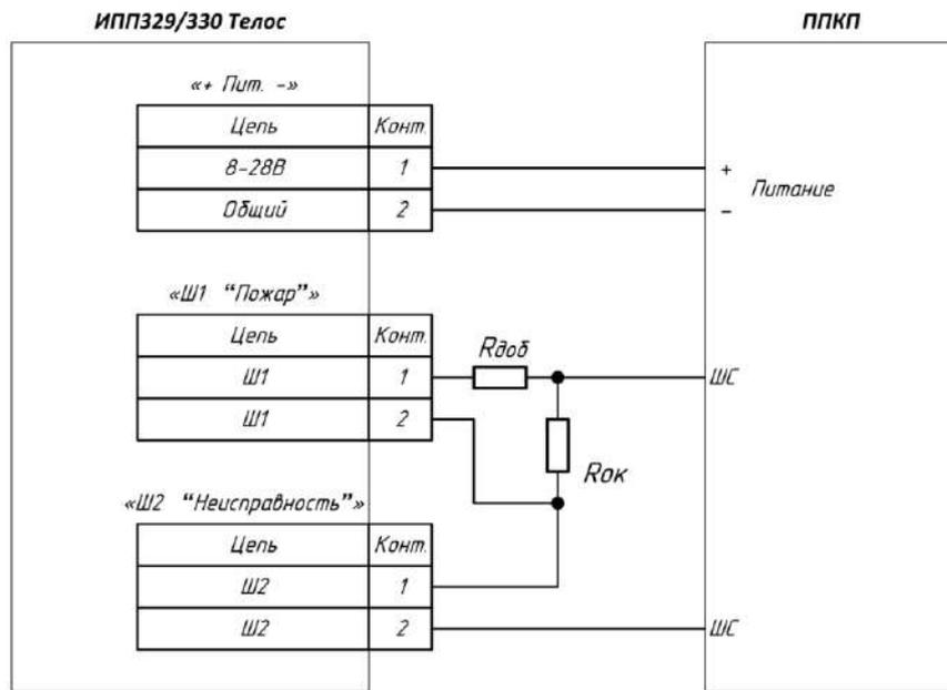
Извещение «ПОЖАР» передается на ППКП путем замыкания контактов реле «Ш1» («ПОЖАР»). Извещение «НЕИСПРАВНОСТЬ» передается на ППКП путем размыкания контактов реле «Ш2» («НЕИСПРАВНОСТЬ»). Оконечный (Rок.) и добавочный (Rдоб.) резисторы выбираются в соответствии с руководством на ППКП.
