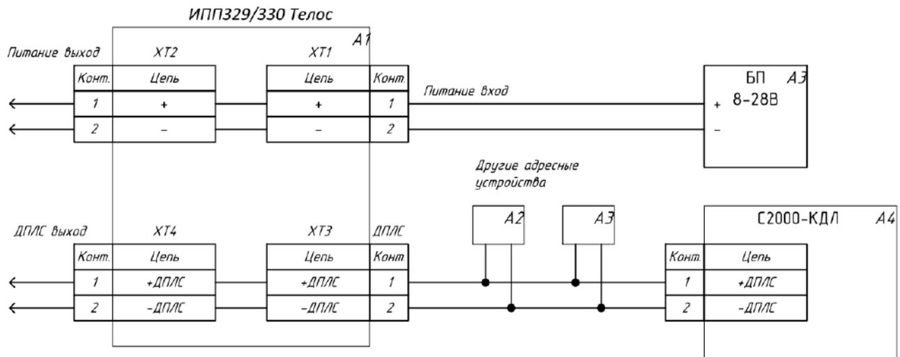
Питание извещателя осуществляется от отдельного блока питания. Напряжение питания 8-28В. Соблюдать полярность. Извещение «ПОЖАР» передается на ППКП по двухпроводной линии связи ДПЛС v2.xx «Орион». *Примечание.* Сигнал извещателя «НЕИСПРАВНОСТЬ» передается с помощью команды ДПЛС «Взлом корпуса».
