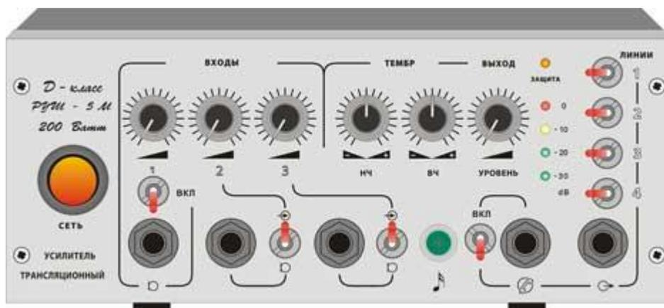
Чтобы избежать любого громкого неожиданного шума из динамиков, сначала включите питание устройств – звуковых источников. Пример: Звуковой источник (внешнее устройство) > **РУШ 5М/ТУ 201** При выключении питания звуковой системы, выполните действия в обратном порядке
