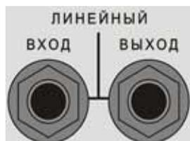
Разъём универсального входа 3 и разъём линейного входа (только для **ТУ 201**, в **РУШ 5М** на месте этих разъёмов заглушки) дублируют аналогичные разъёмы на передней панели.
