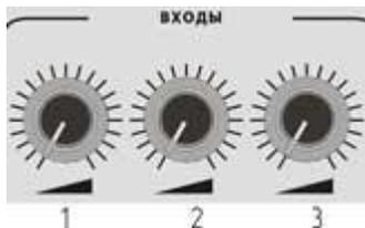
На рисунке регуляторы в «начальном» положении. Чтобы обеспечить оптимальный баланс между соотношением «сигнал-шум» и динамическим диапазоном, отрегулируйте уровень сигнала этими регуляторами так, чтобы на выходе (на контрольном громкоговорителе) сигнал на слух ото всех источников был одинаков.
