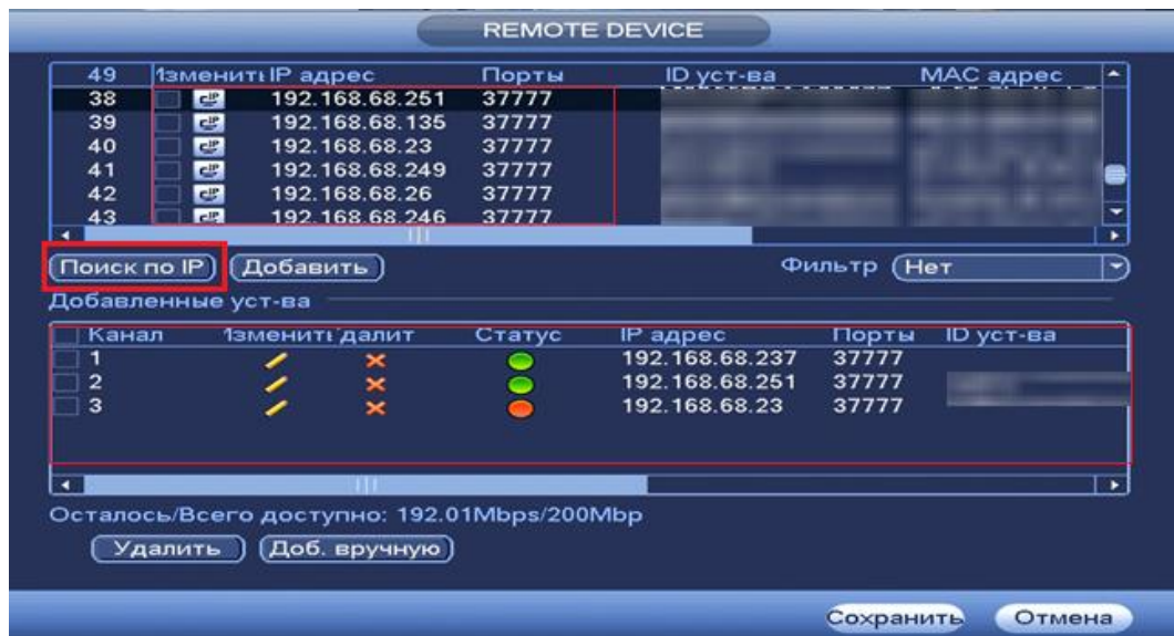
Рисунок 6.2.5.2 Настройка добавления камер по поиску в сети.
