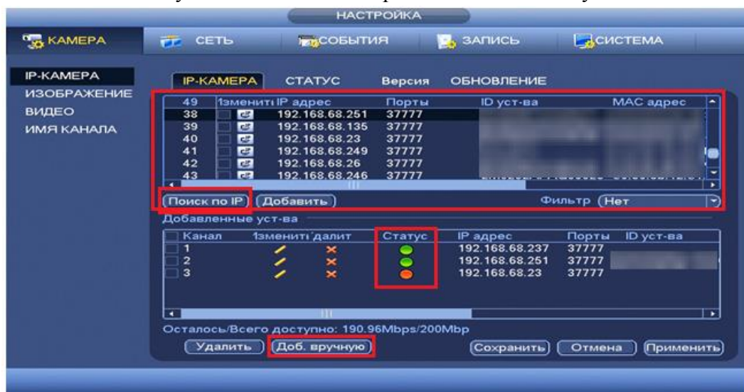
Рисунок 8.3.1.1.2 Настройка добавления камер по поиску в сети.
