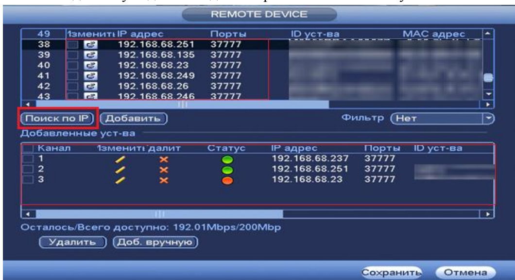
Рисунок 7.7.2 Настройка добавления камер по поиску в сети.
