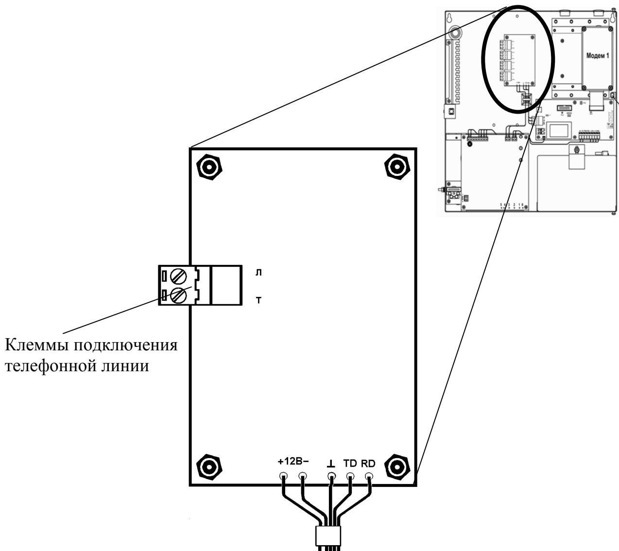
Клеммы подключения телефонной линии
