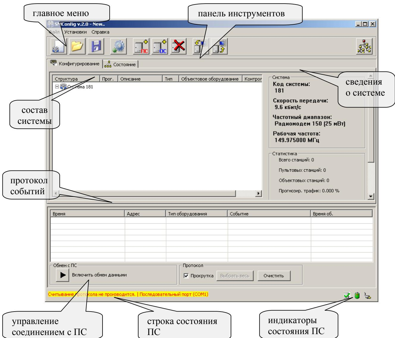
Вкладка "Конфигурирование" предназначена для выполнения конфигурирования состава РСПИ и изменения параметров приемопередающих станций.
