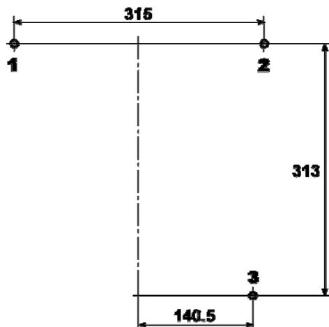
2. Вверните шурупы в отверстия 1 и 2 и навесьте на них станцию.
