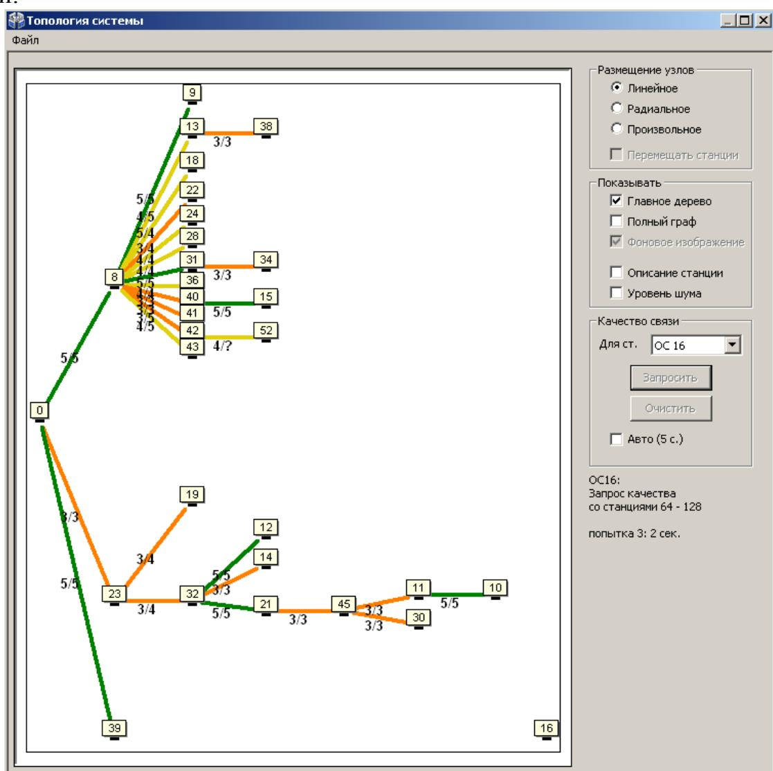
Пользователем могут быть выбраны различные виды отображения сетевой топологии в зависимости от способа размещения узлов на графе (поле "Размещение узлов"). Линейное, либо радиальное размещение узлов может быть полезным для быстрого анализа только что установленной радиосистемы.
