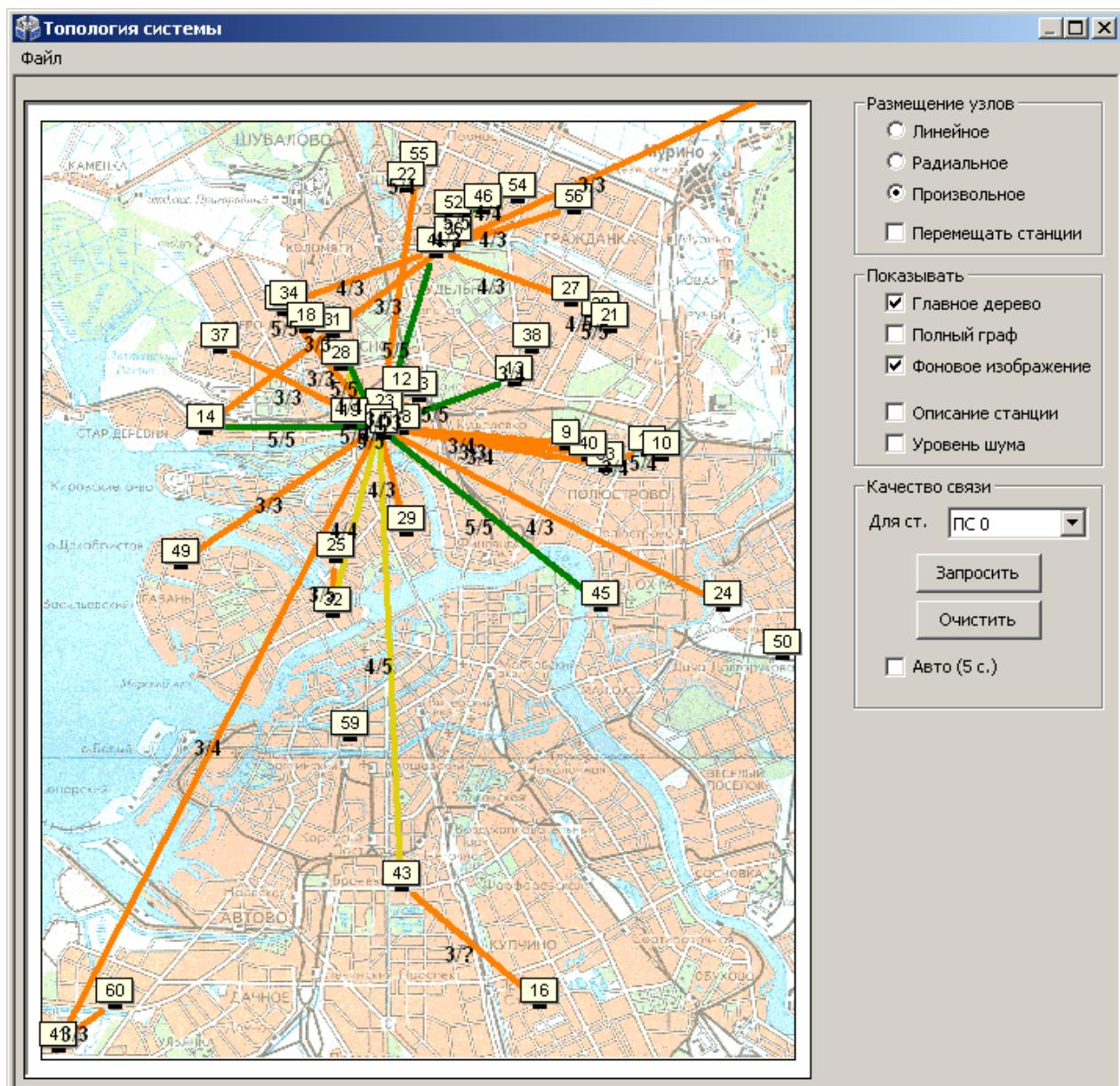
Линии, соединяющие каждую пару узлов на графе, имеют различный цвет в зависимости от условий качества связи между этими узлами.
