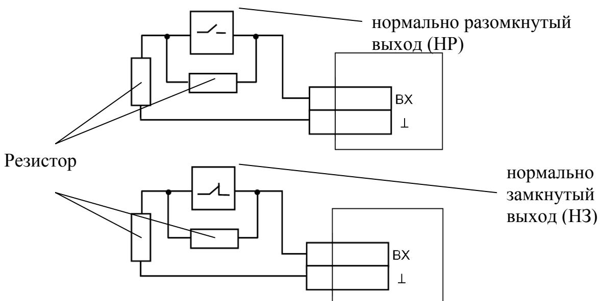
При подключении выхода "Неисправность" приемно-контрольного прибора к входу MBK-RS используется только один оконечный резистор. Резистор следует включить в цепь последовательно с НЗ выходом или параллельно НР выходу:
