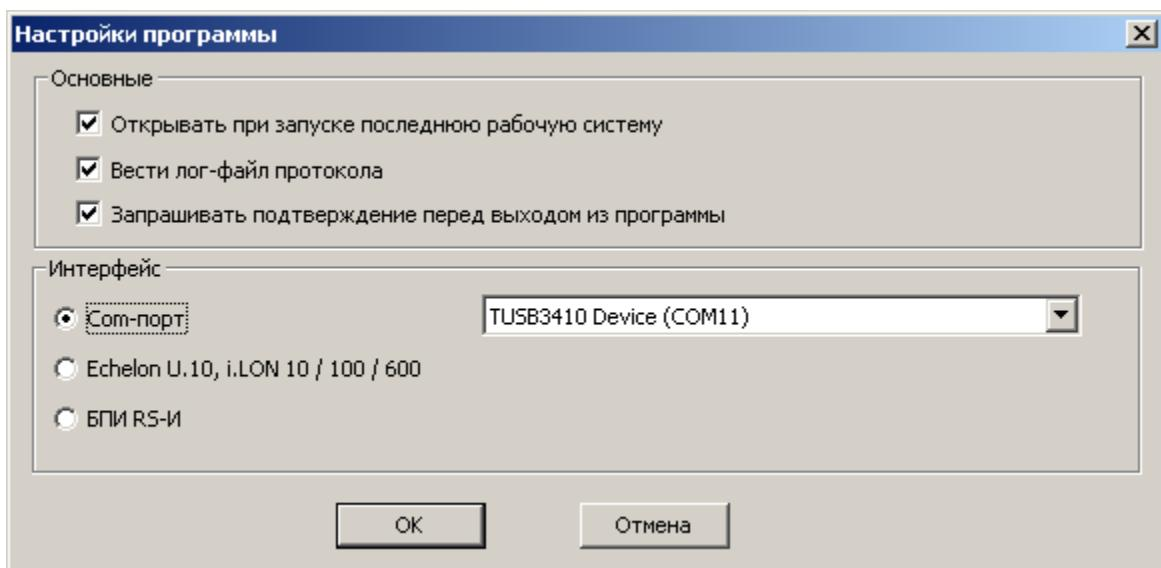
Установка галочки "Открывать при запуске последнюю рабочую систему" приводит к автоматическому открытию последней сохраненной системы при запуске программы.
