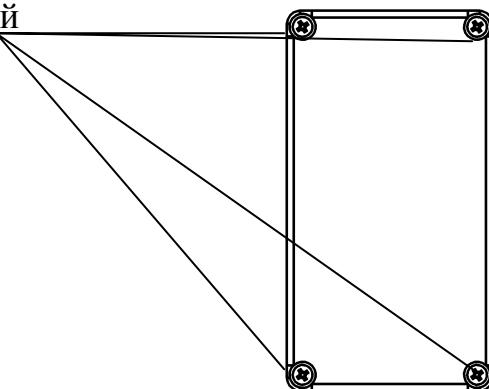
2. Снять крышку радиомодема.
