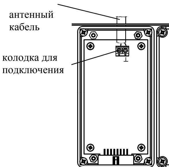
3. Подключать antennу следует кабелем с волновым сопротивлением 50 Ом. Рекомендации по выбору кабелей и антенн находятся в разделе 6.4.
