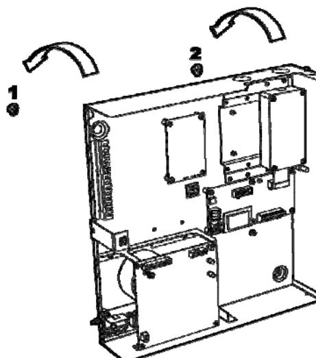
3. Для крепления станции ввинтите шуруп в отверстие 3 в его нижней части. Предварительно снимите крепление аккумулятора и извлеките батарею из корпуса.
