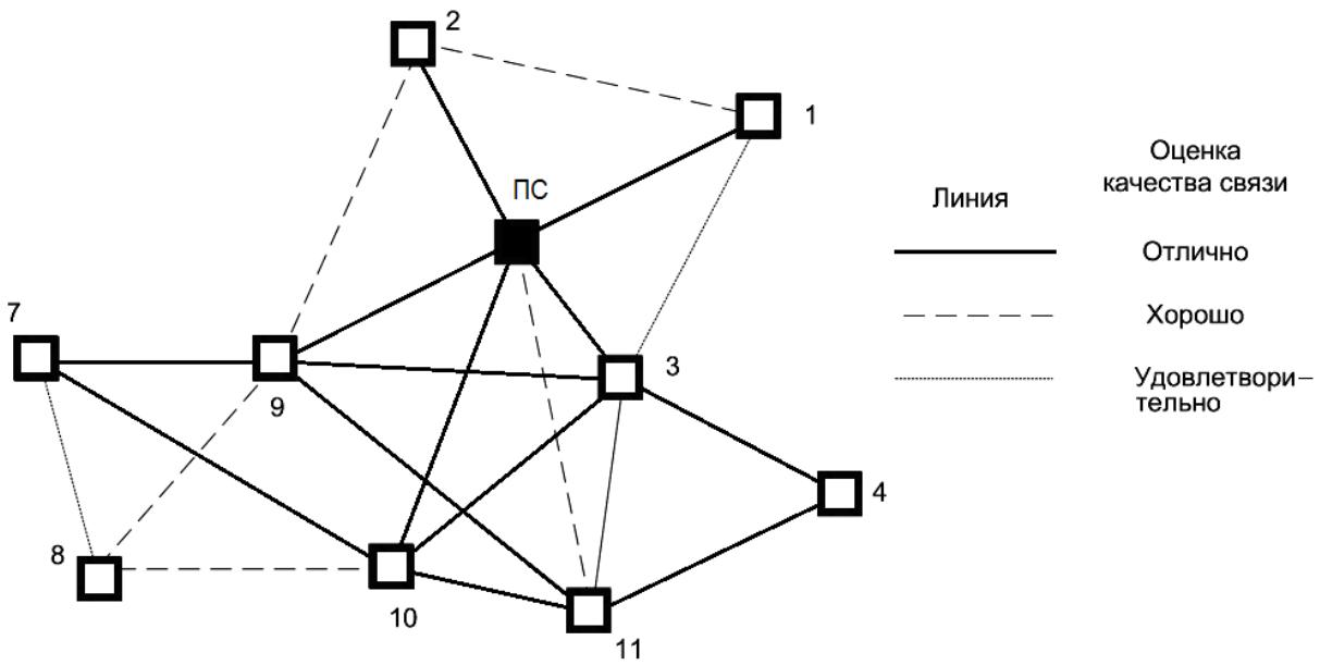
Практическая полезность представления топологии радиосистемы в виде полного графа заключается в том, что анализ такого графа позволяет сделать вывод о наличии всех потенциально возможных путей передачи радиосигналов от каждой станции РСПИ к пультовой станции.
