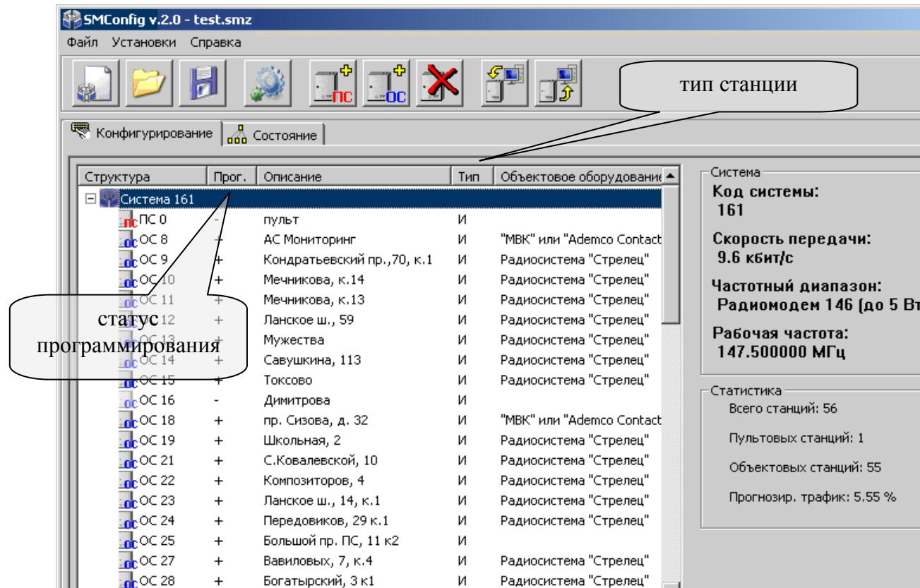
5.4.5 Программирование станции осуществляется нажатием кнопки на панели инструментов или через контекстное меню. В первую очередь проводится программирование объектовых станций, затем программируется ПС.
