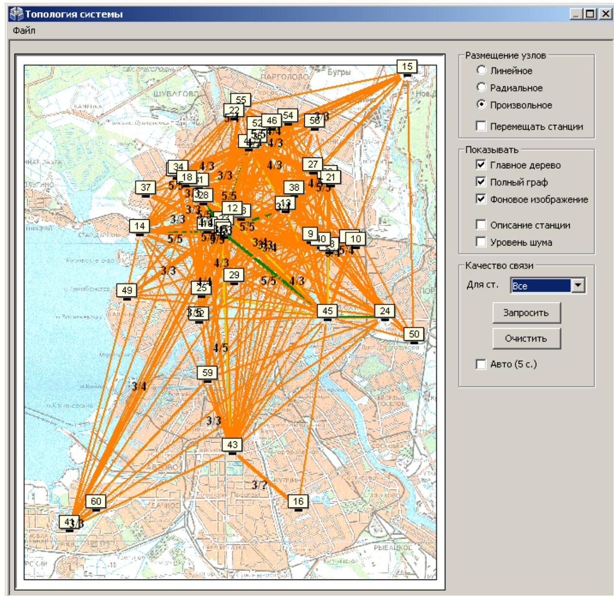
На полном графе показываются все доступные связи между каждой парой станций, поэтому в общем случае количество линий может быть очень большим, что затрудняет его анализ. Поэтому в окне имеется возможность включения опций фильтрации для отображения полного графа.
