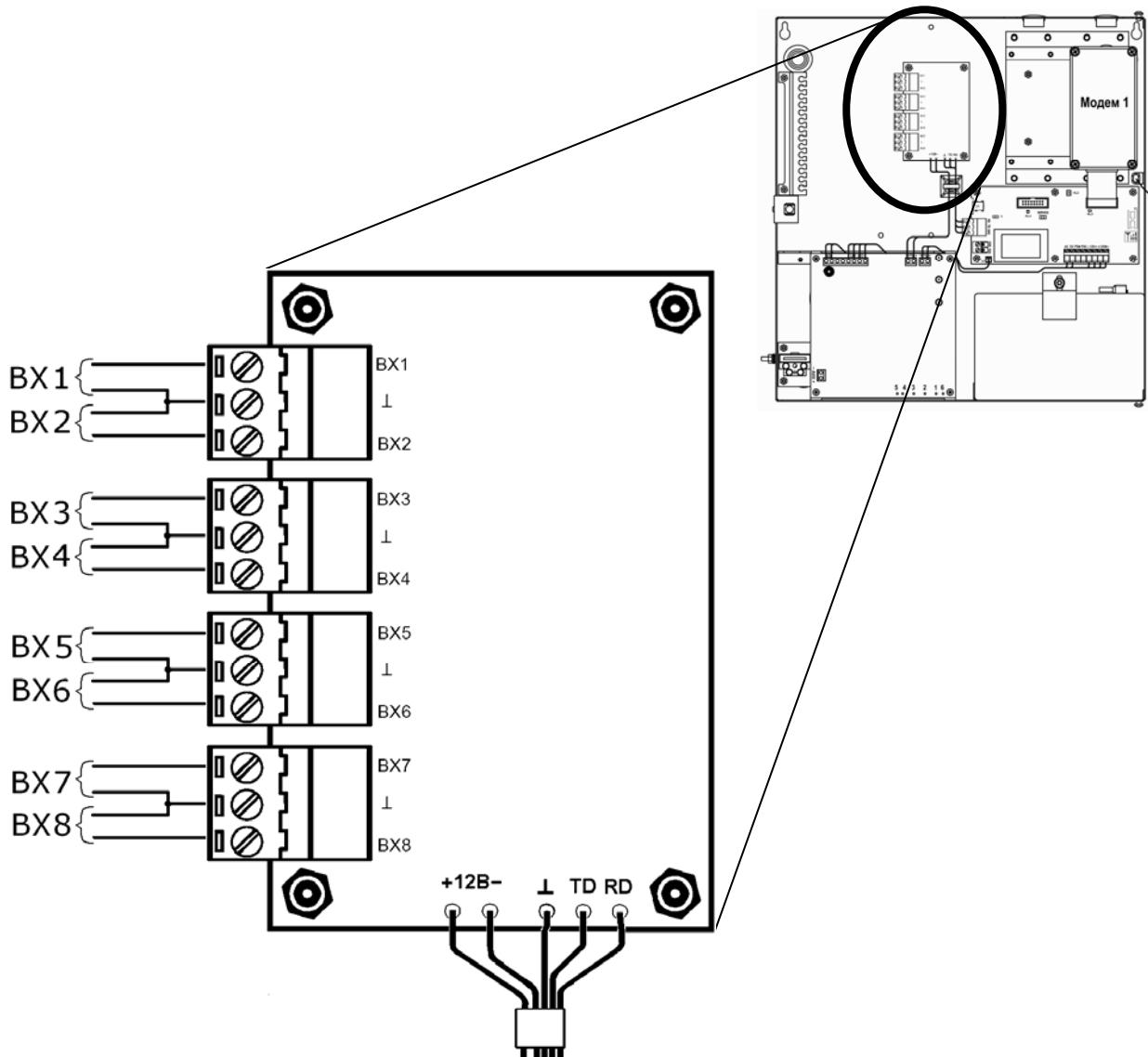
Модуль имеет 8 входов контроля "BX1"- "BX8" для подключения выходов типа "открытый коллектор" приемно-контрольного прибора или реле на размыкание или замыкание.
