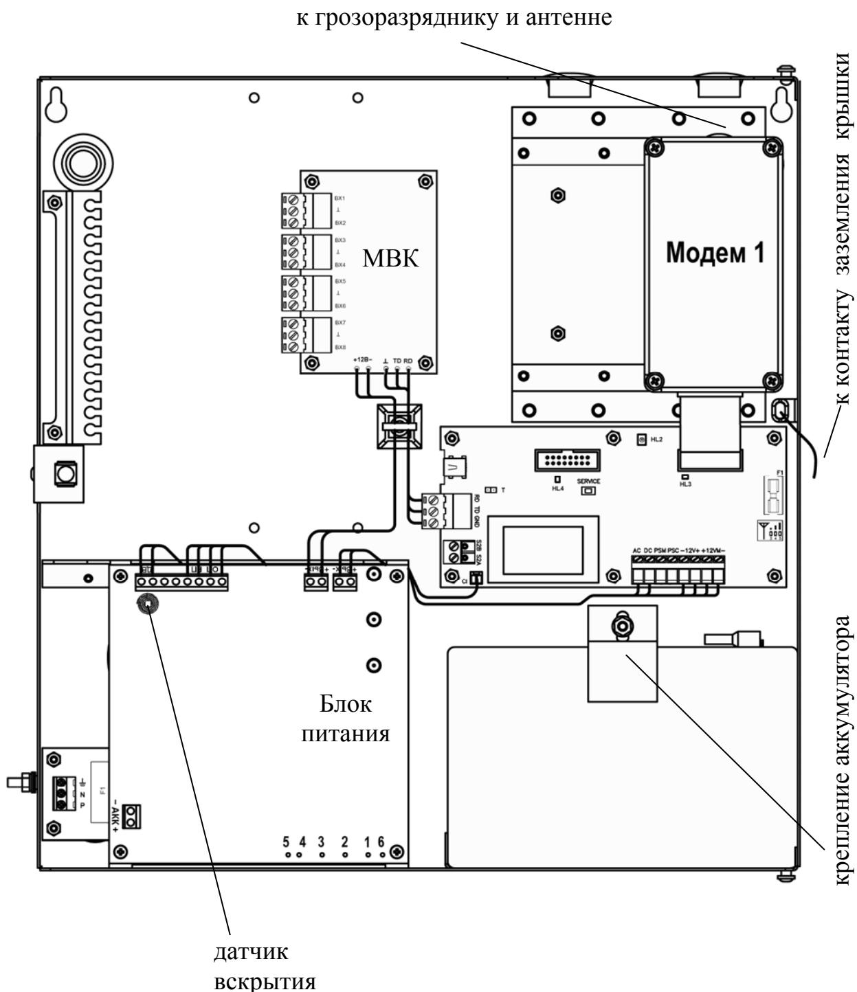
К управляющей плате при помощи кабелей подключаются радиомодем №1 ("Modem1").
