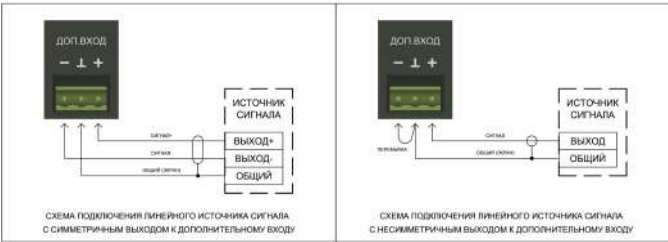
Рис.6 Схема подключения источника линейного сигнала к входу «ДОП.ВХОД».
