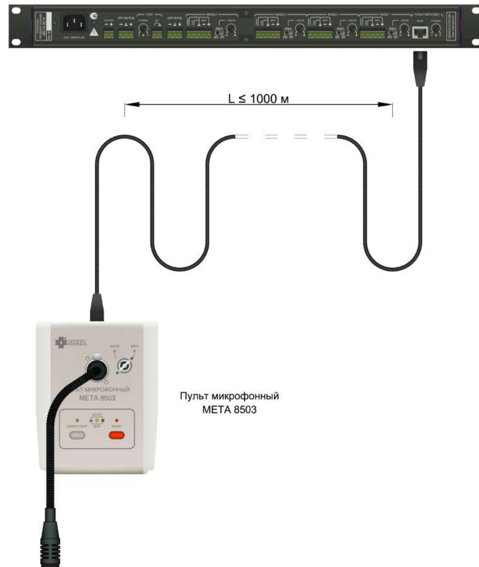
Рис.8 Схема подключения многофункционального микрофонного пульта META 8503.
