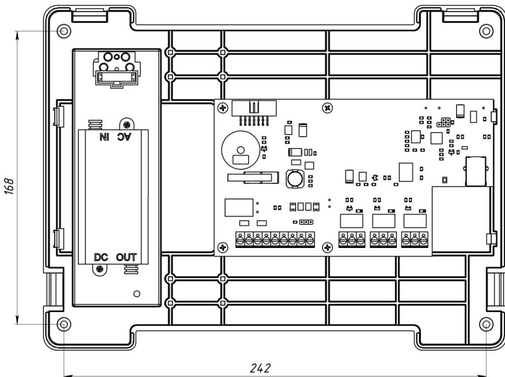
6.2. Для открытия корпуса необходимо вручную отогнуть защелки с обеих сторон крышки по направлению стрелок, после этого открыть крышку на угол 45 градусов. Затем снять крышку с основания.
