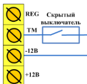
Рисунок 6.2 — Схема подключения скрытого выключателя или кнопки
