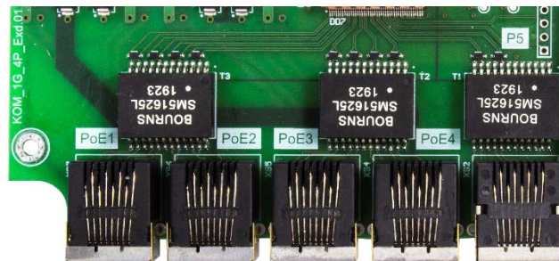
Рисунок 5. Порты Ethernet коммутатора
