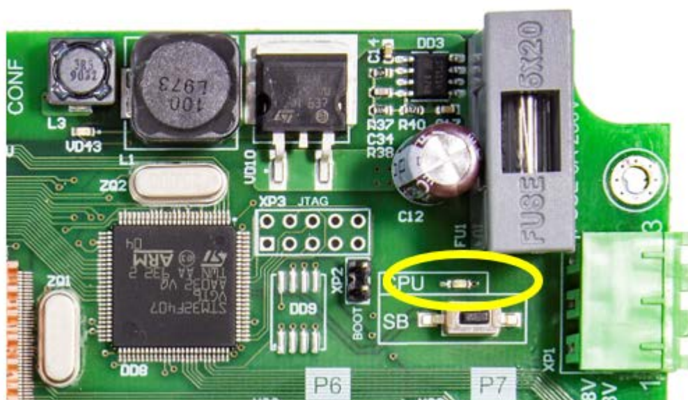
Рисунок 9. Расположение элементов индикации и настройки на плате коммутатора.
