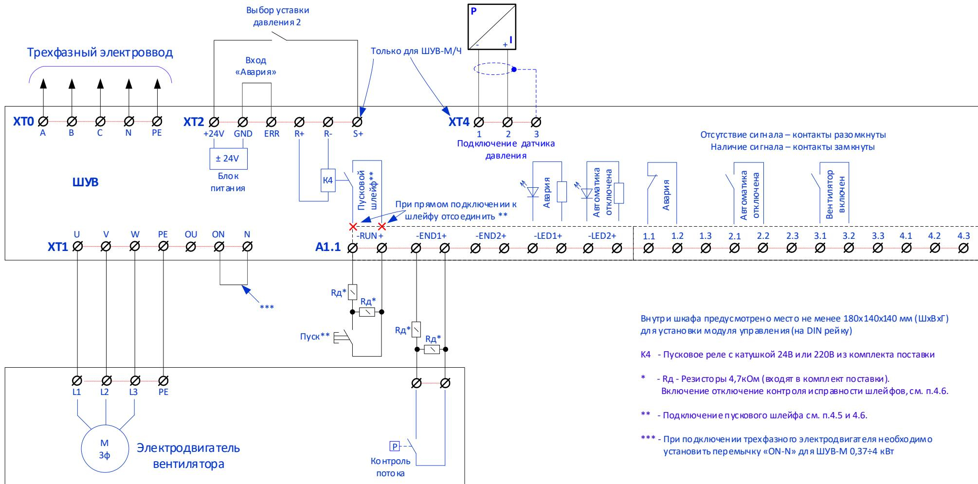
Подключение однофазного вентилятора для ШУВ 0,37÷4,0 кВт:
