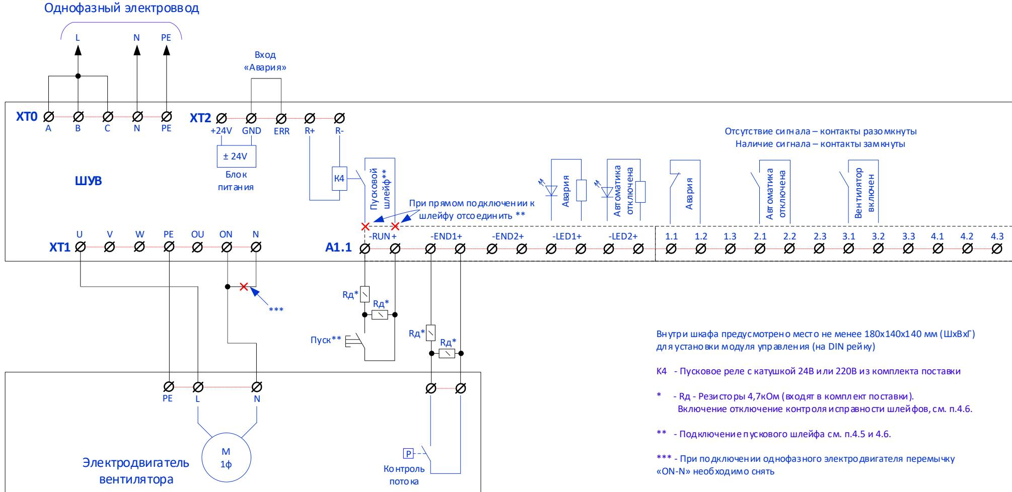
Схема подключения электрического воздухонагревателя для ШУВ+ТЭН:
