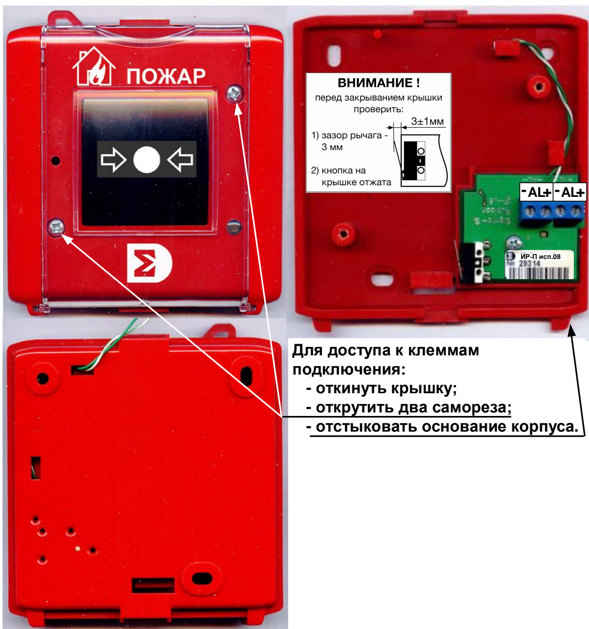
Рис. 2 ИР-П . Внешний вид, клеммы подключения.
