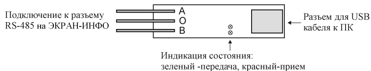
Рисунок 5. Расположение контактов преобразователя ПИ1.
