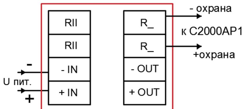
Рисунок 4 – Схема подключения извещателя к C2000AP1
