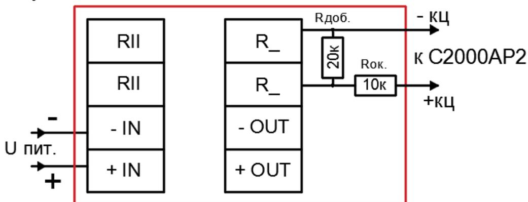
Рисунок 5 – Схема подключения извещателя к C2000AP2
