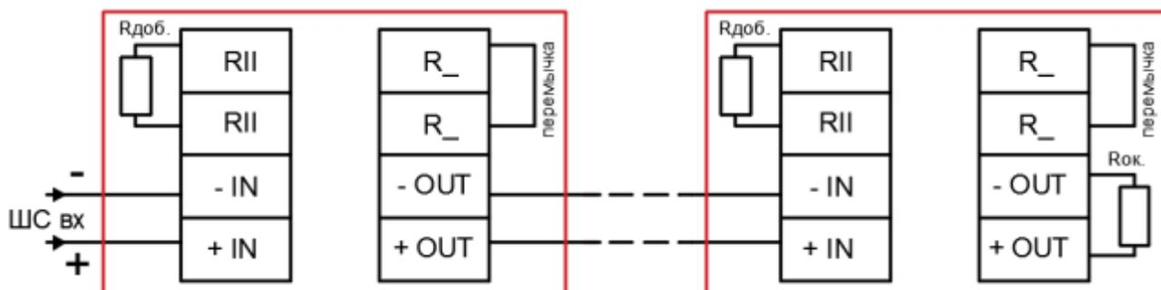
Рисунок 3 – Схема параллельного подключения извещателя
