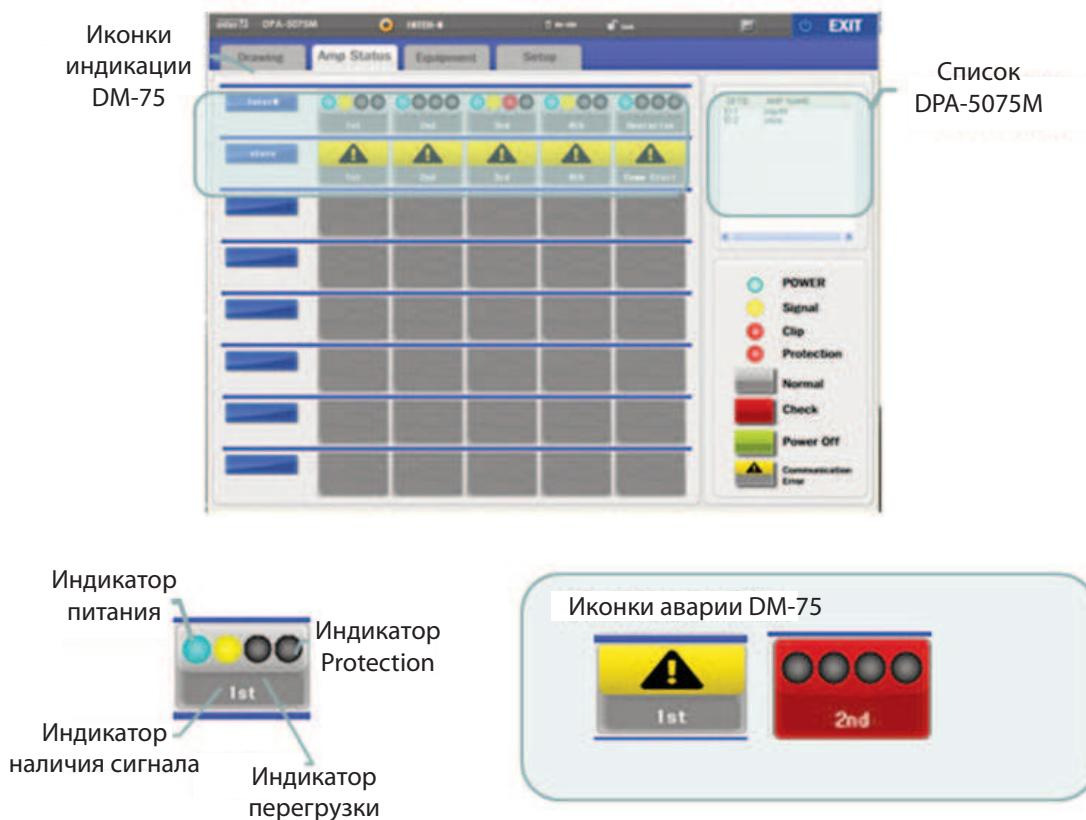
Двойное нажатие курсором мыши на какую-либо иконку DM-75 автоматически переводит пользователя на вкладку **Equipment**, где можно просмотреть более подробную информацию о каждом модуле.
