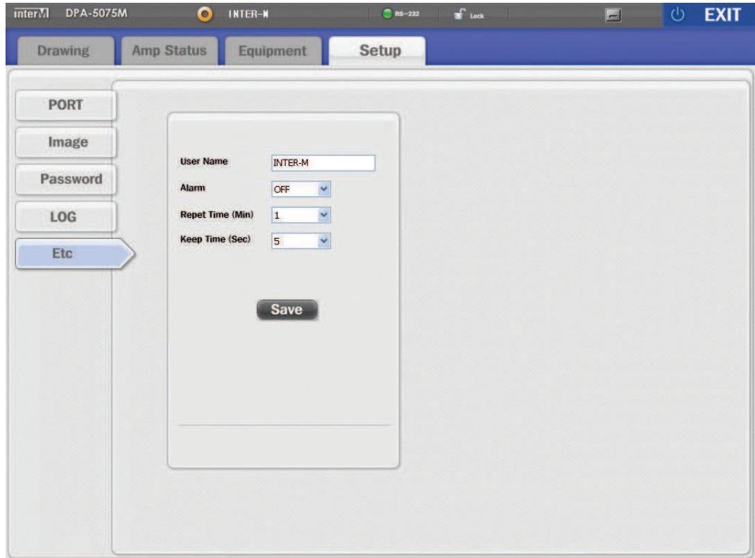
Сигнализацию можно включить или выключить (ON/OFF), настроить период повторения (Repeat Time) в минутах, время проигрывания (Keep Time) в секундах. При нажатии кнопки Save сохраняются текущие настройки.
