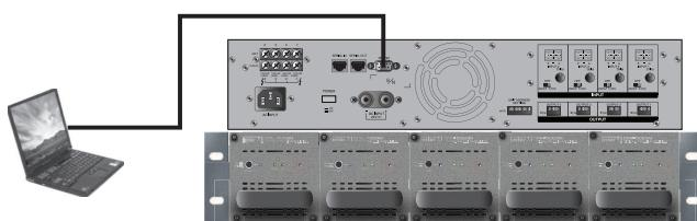
Усилители можно объединить в сеть на основе интерфейса RS-422. Соединение усилителей выполняется последовательно — выход одного устройства со входом следующего. Максимальное расстояние между окончательными устройствами сети составляет 1 км.
