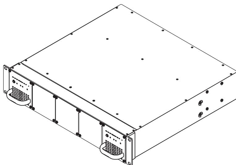
Перед установкой дополнительного модуля рекомендуется отжать кнопку включения питания на его передней панели.
