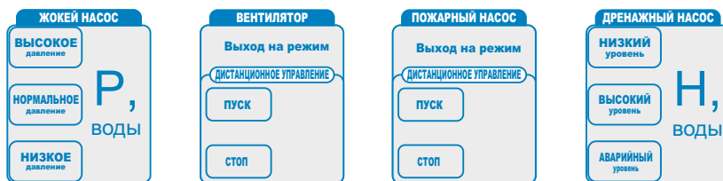
Рисунок 5- Сменная этикетка панели управления ШУ
