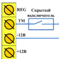
Рис. 8.2. Схема подключения скрытого выключателя
