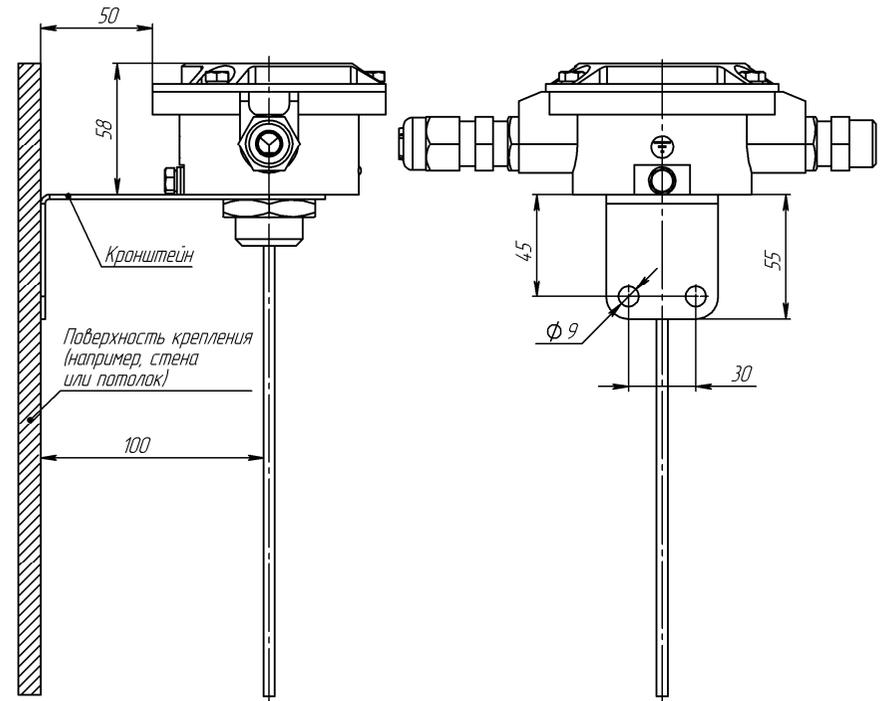
**Рисунок 2.** Пример крепления извещателя с помощью кронштейна.
