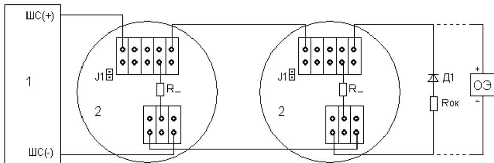
а) Схема подключения ИП101-07е на размыкание
