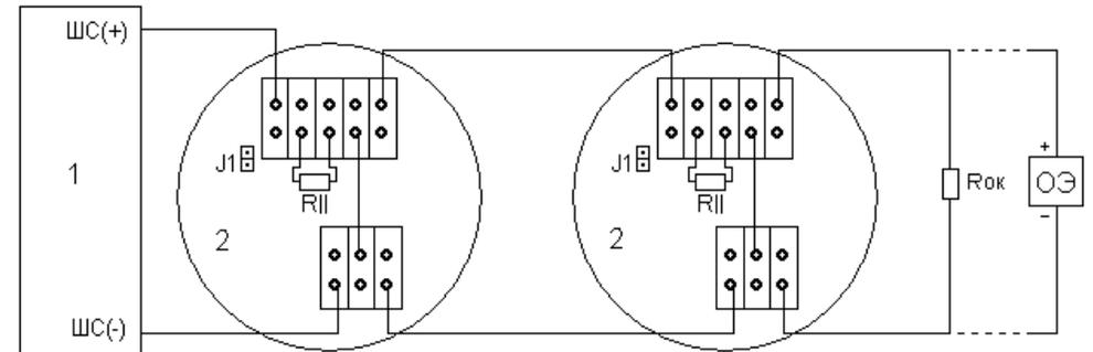
б) Схема подключения ИП101-07е на замыкание
