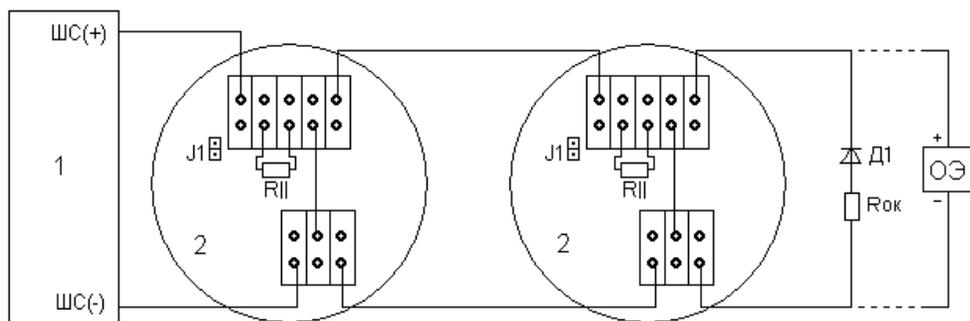
б) Схема подключения ИП101-07е на замыкание
