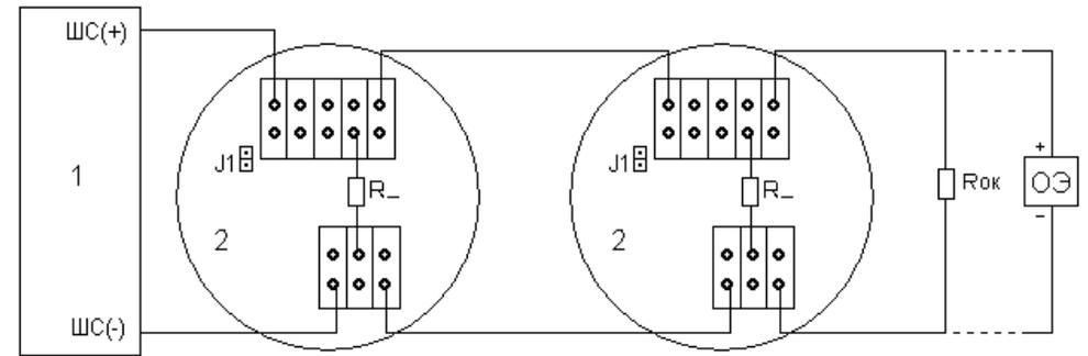
а) Схема подключения ИП101-07е на размыкание
