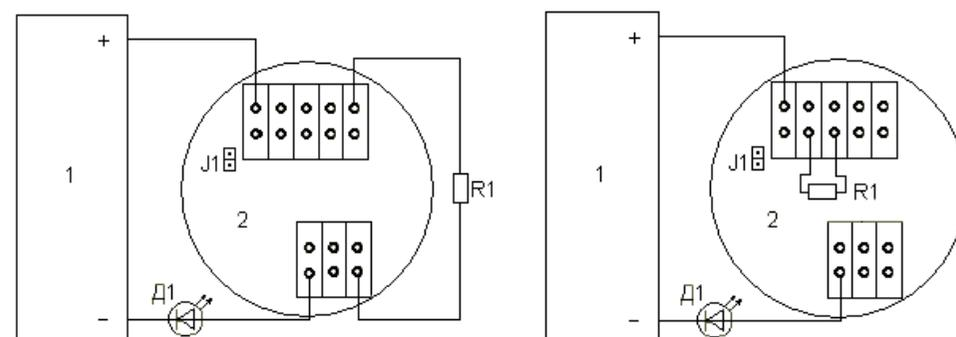
**1** – испытательный стенд с источником питания 8-28 В; **2** – извещатель; **R1** – ограничивающий резистор 1-2 кОм; **Д1** – контрольный светодиод; **J1** – перемычка вкл/откл фиксации при срабатывании.
