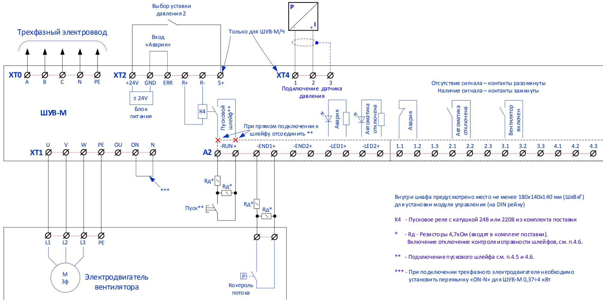
Подключение однофазного вентилятора для ШУВ 0,37÷4,0 кВт:
