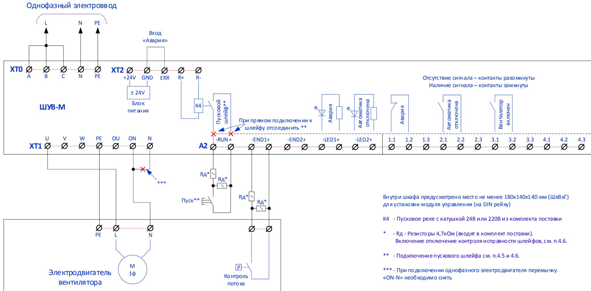
Схема подключения электрического воздушонагревателя для ШУВ+ТЭН:
