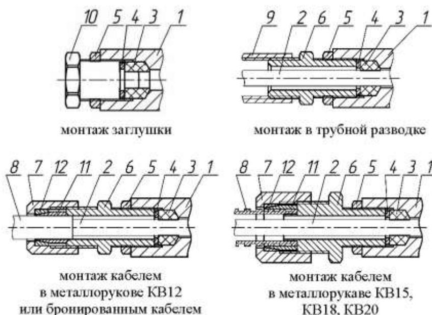
Рисунок 13 – Различные вводные устройства
