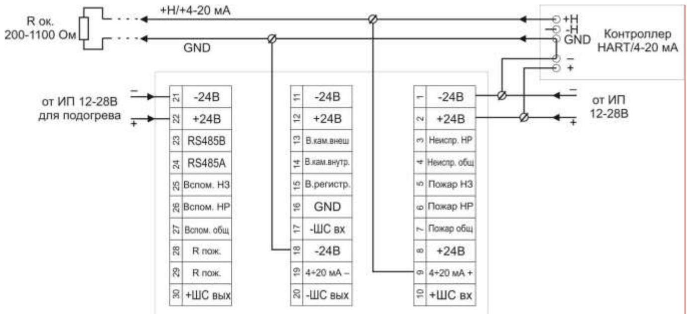
Рисунок 10 – Схема подключения по интерфейсу HART с вытекающим током
