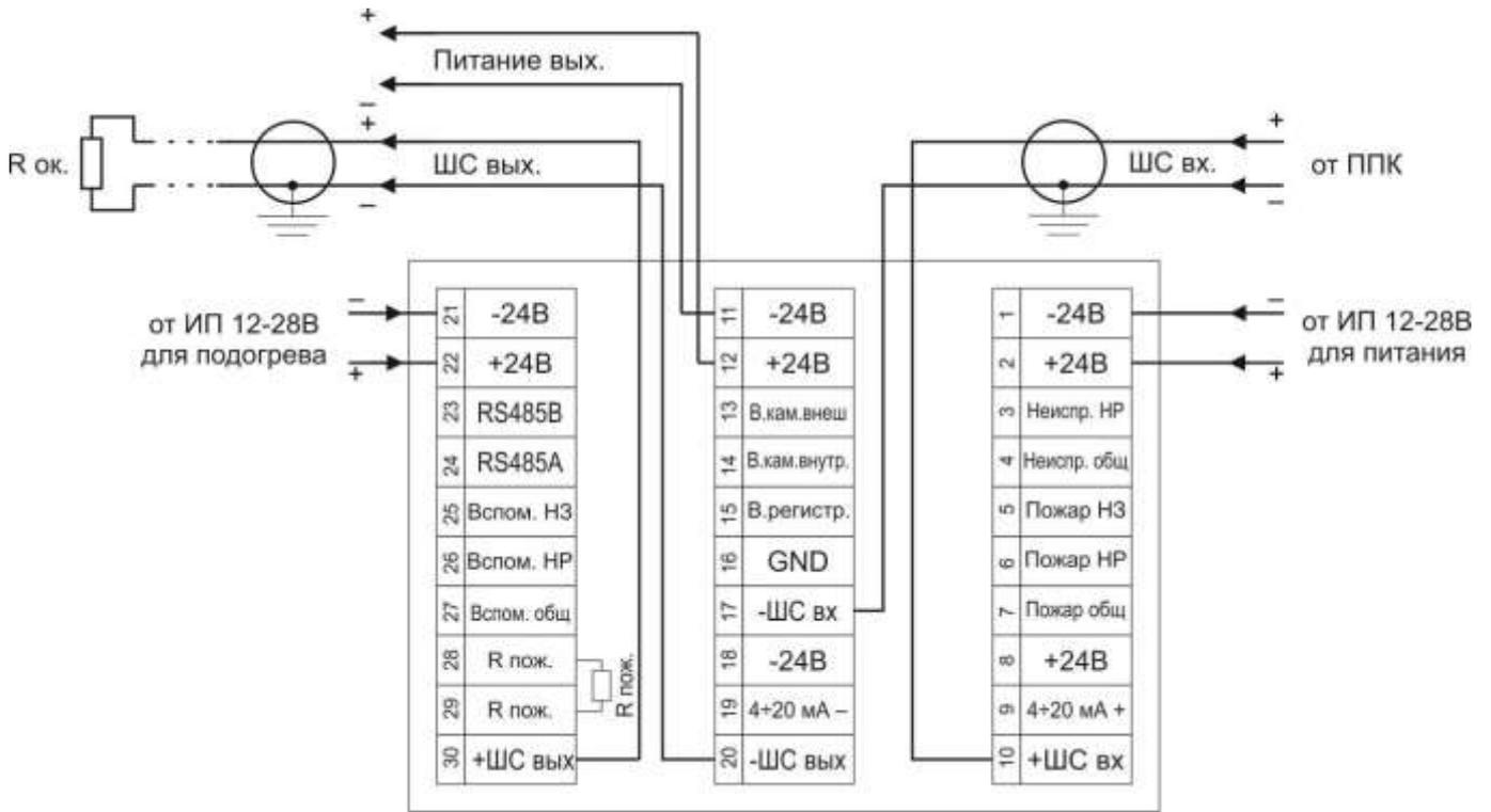
Рисунок 9 – Схема подключения от ППК
