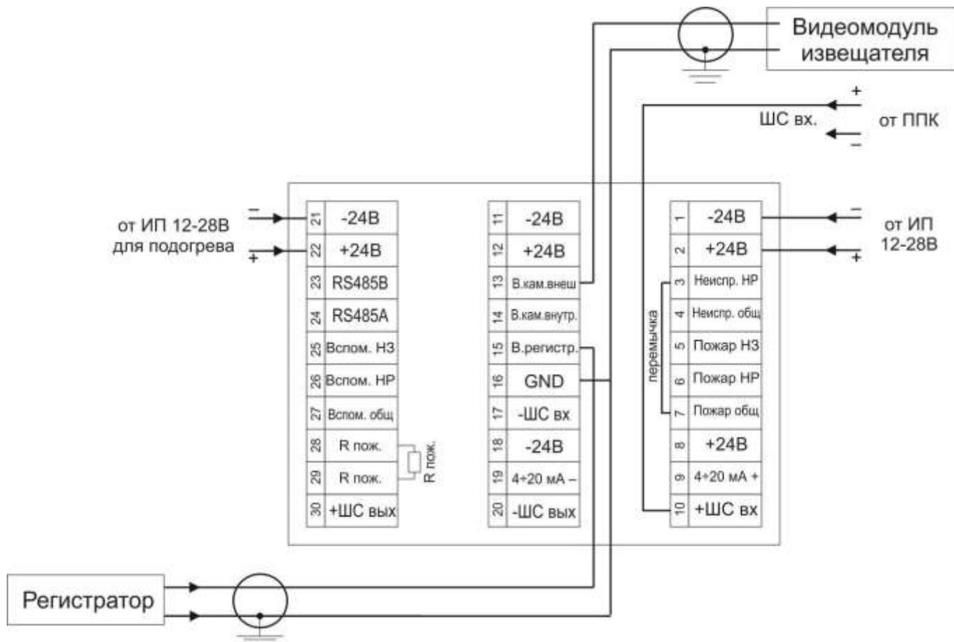
Рисунок 13 – Схема подключения извещателя с видеомодулем
