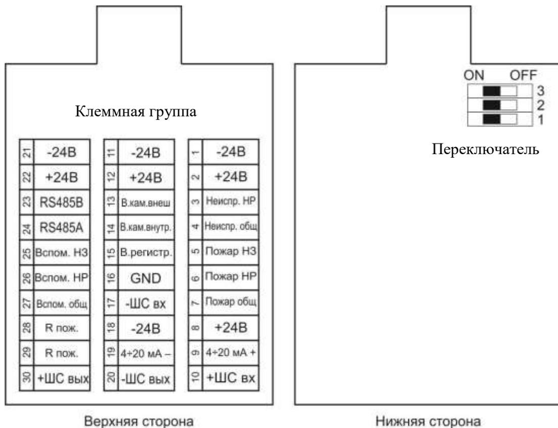
Рисунок 8 – Клеммная плата извещателя
