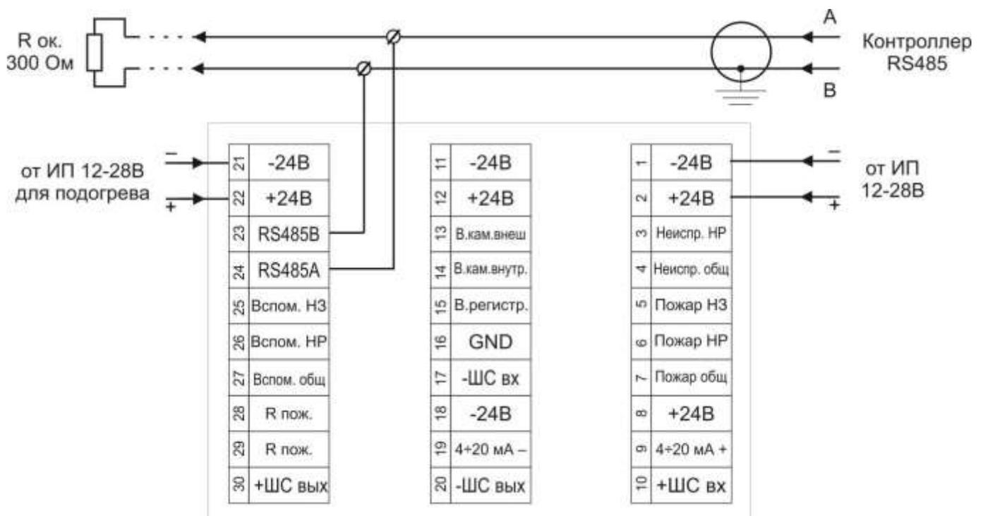
Рисунок 12 – Схема подключения по интерфейсу RS485
