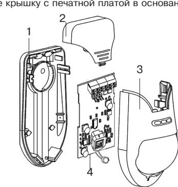
Рисунок 3 – Конструкция извещателя
