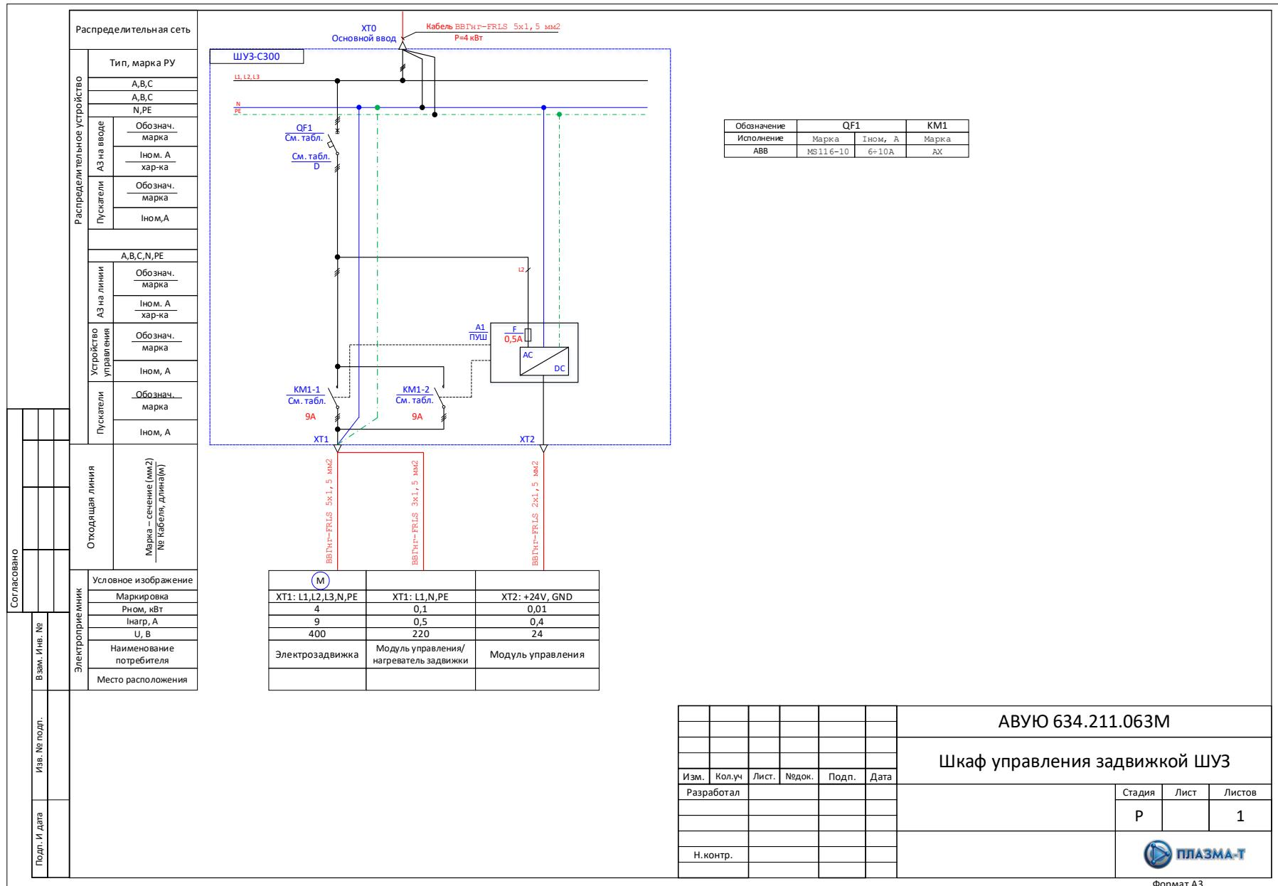
Однолинейная схема ШУЗ: подключение однофазного электропривода
