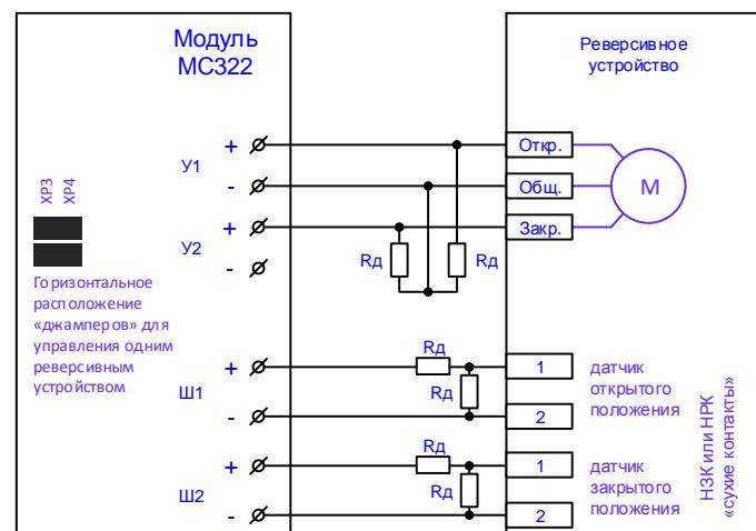
Rd – резисторы 4,7 кОм, 0,25 Вт установить на клеммах привода
