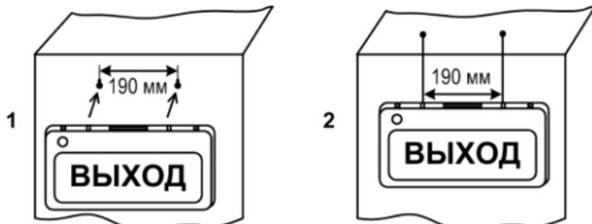
Рис.1 Установка оповещателя
