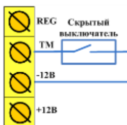
Рисунок 3.2 — Схема подключения скрытого выключателя
