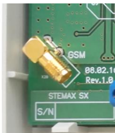
Рисунок 3.1 — SMA-разъем для подключения GSM-антенны
