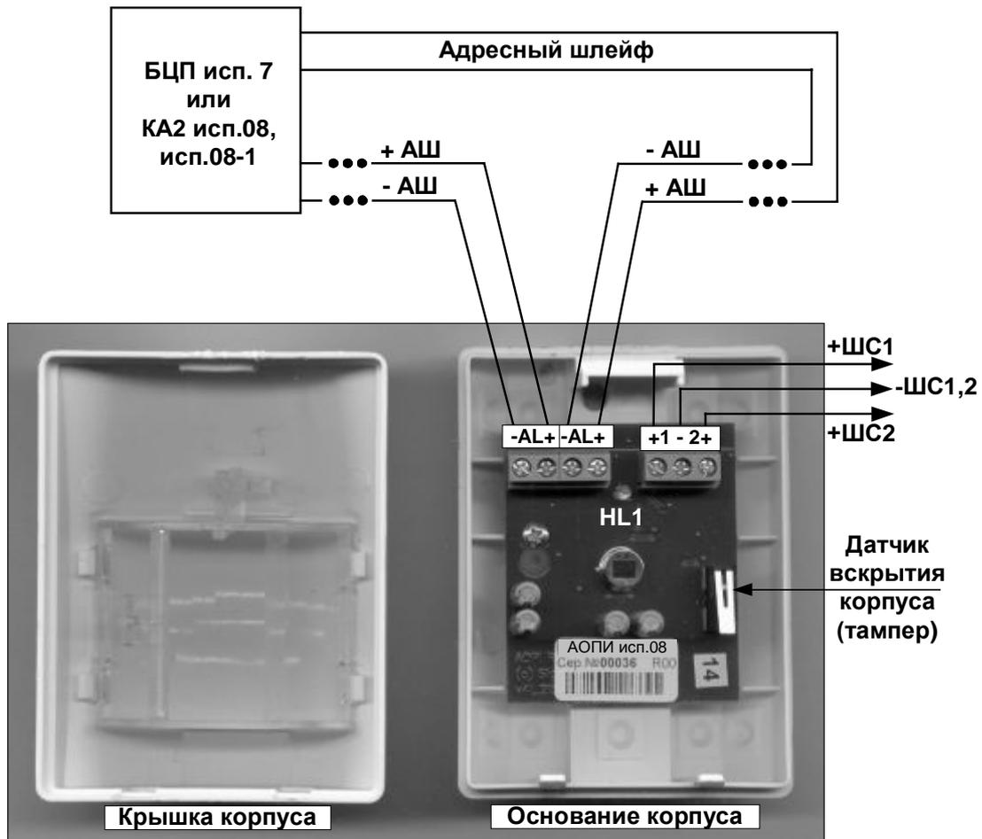
Рис. 2 Конструкция, подключение устройства
