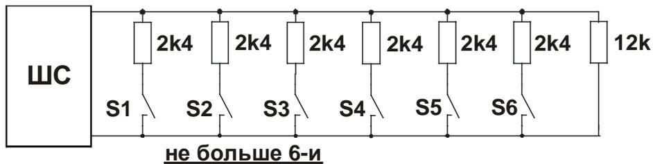
Рис. Схема 8 Параллельное подключение нескольких НР извещателей.
