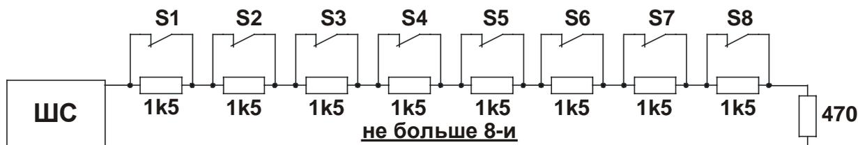
Рис. Схема 7 Последовательное подключение нескольких НЗ извещателей.
